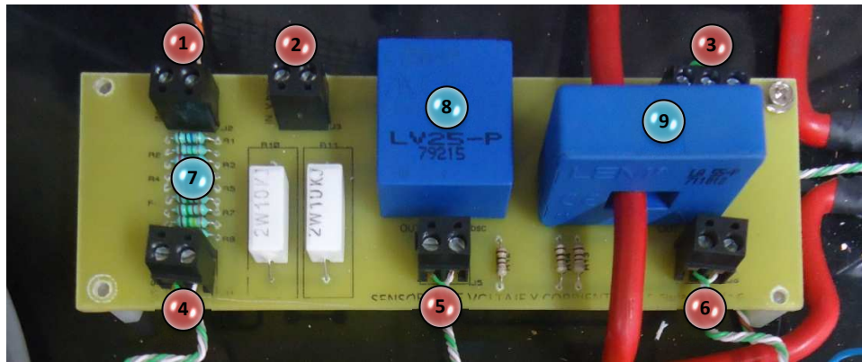
Figura 5-14. Implementación de Tarjeta de Sensores de Voltaje y Corriente
